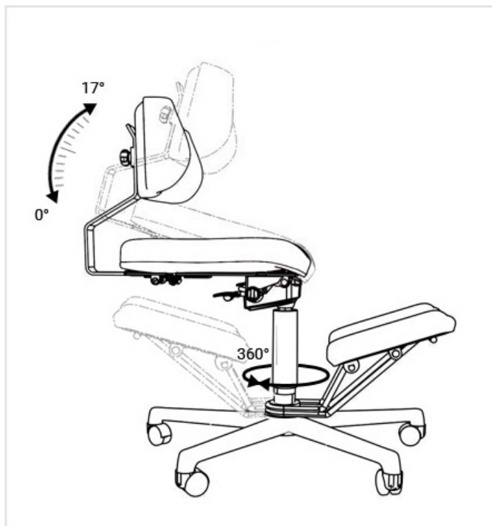
Inclinazione della seduta da 0° a 17° a corsa libera (regolabile a iacere, senza tacche intermedie). Il poggia ginocchia a scomparsa ruota liberamente a 360°
